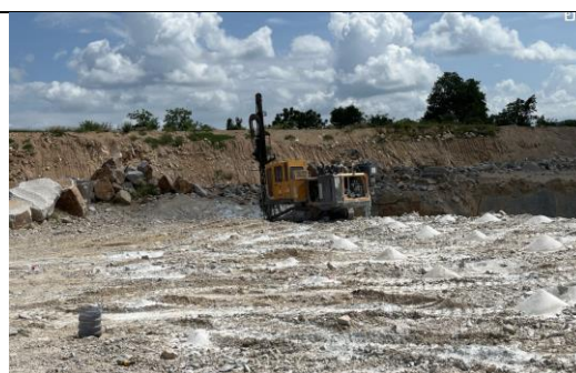
รูป AG การเจาะรูระเบิดจะต้องติดตั้งเครื่องมืออุดฝุ่นที่ บริเวณหัวเจาะ
